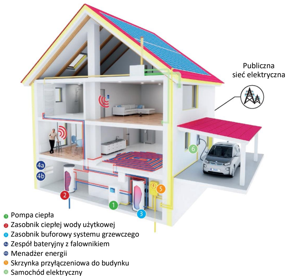
Rys. 12 Wzajemne oddziaływanie zespołów i podzespołów systemu (źródło grafiki BWP)
