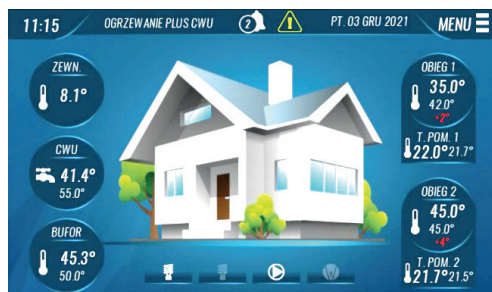
Rysunek 3: Przykładowa korekta temp. zadanej na obiegach
